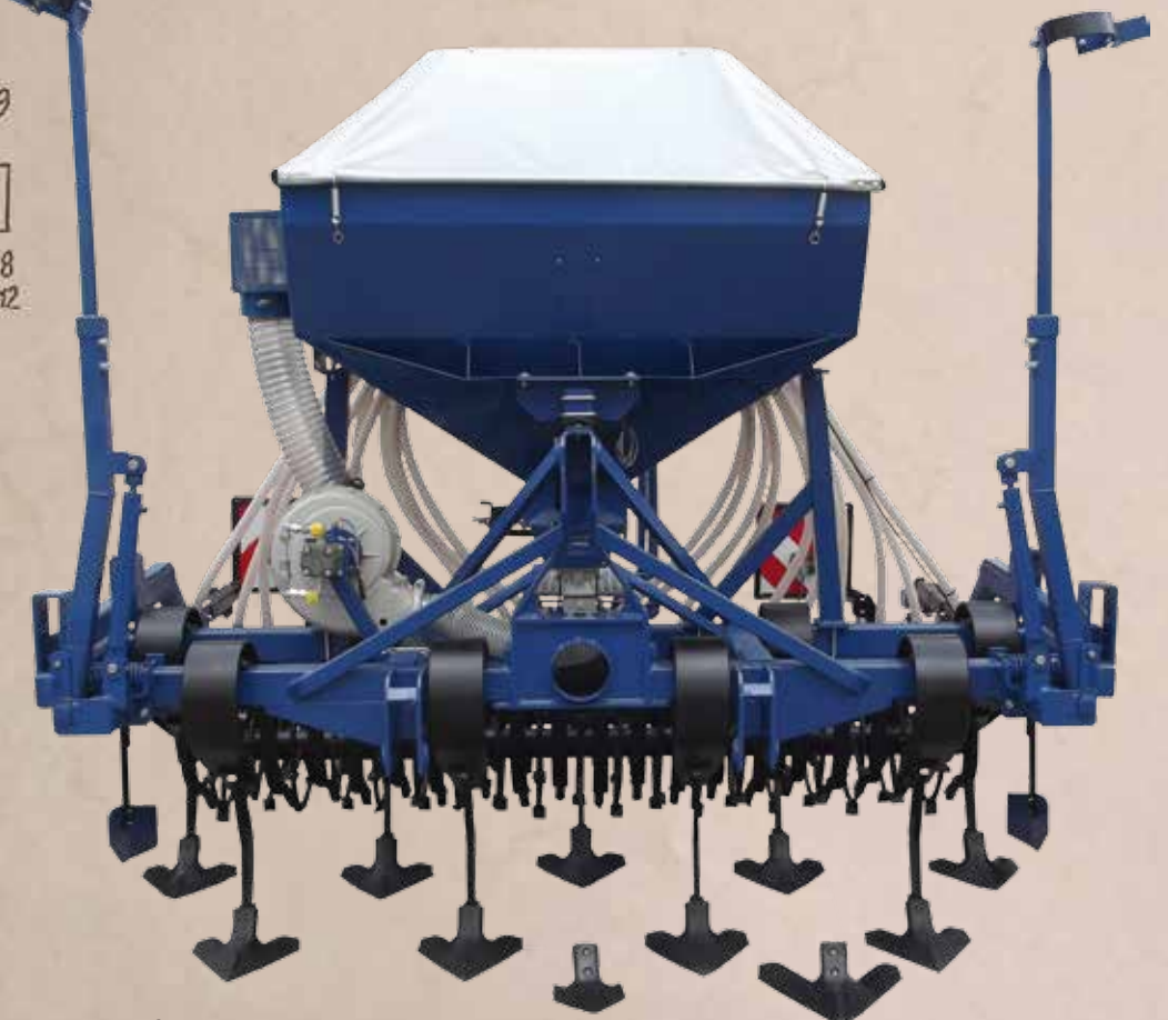
Fig. 02 zeigt Klutenräumer (Zerdrücker) mit Saatgutablage vor dem Andrückrad (Federstempelrad).
